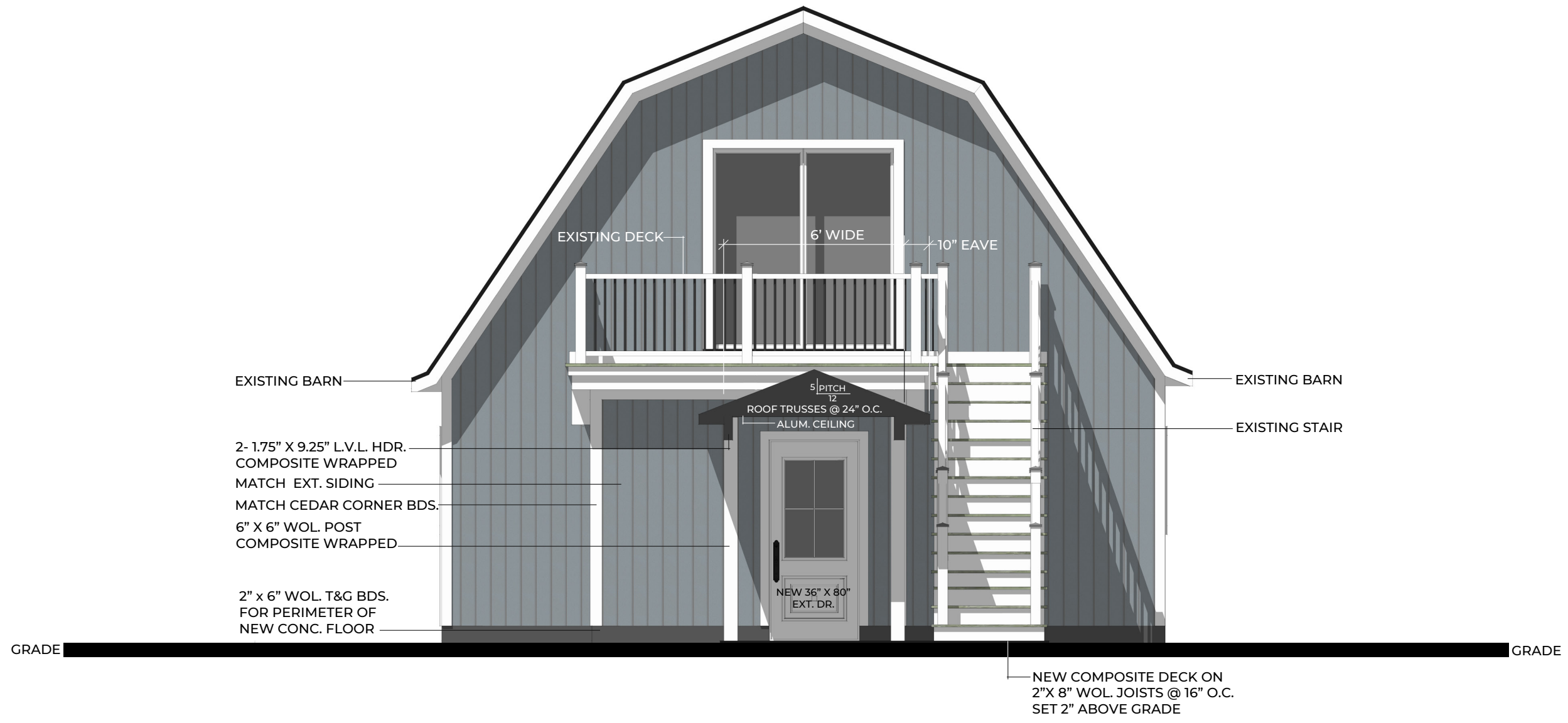
RIGHT SIDE ELEVATION SCALE: 1/4" = 1'- 0"
